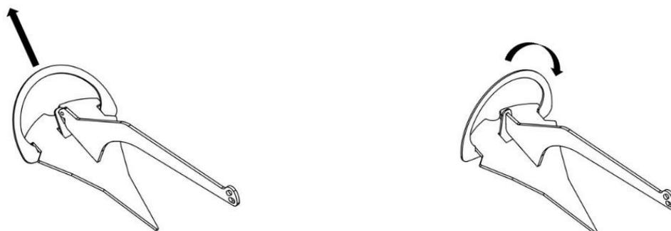
**5** – Finalmente, mediante la colocación del pasador del grillete proporcionado (4) por el orificio situado en el saliente del extremo posterior del brazo portante (1), el conjunto quedará sujeto de forma estable y segura para su utilización, no siendo posible su desacoplamiento sin la destrucción de la unidad.
