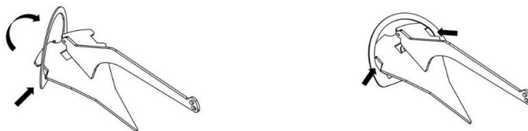
**4** - Insertar a continuación el saliente del extremo posterior del brazo (1) en el orificio rectangular central del cepo de posicionamiento (3).
