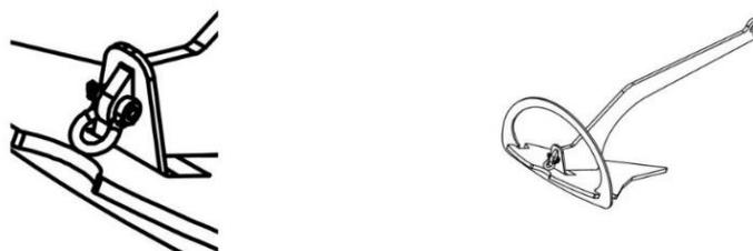
Compruebe que su Ankerplex ha sido montada de la forma indicada, y a continuación conecte ésta a la línea de fondeo mediante un grillete de calidad u otro procedimiento adecuado.
